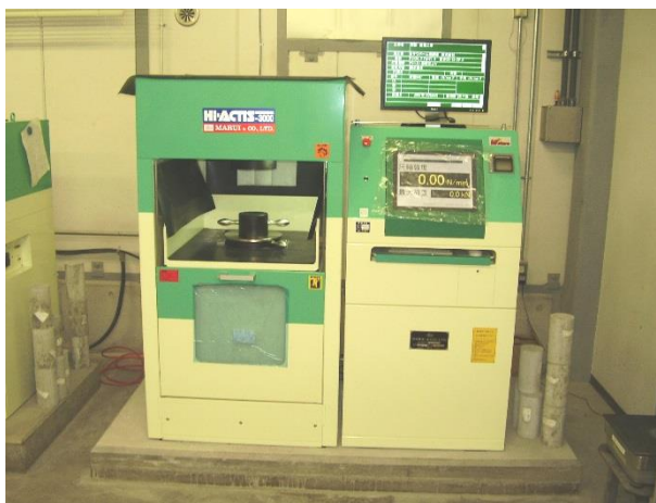
硬化コンクリートの圧縮強度試験
