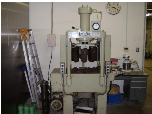
・ 曲げ試験機鉄筋
